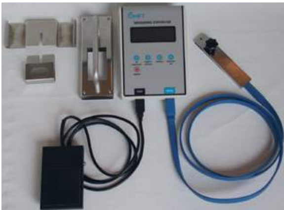
Afbeelding 6: Measuring Station 430. Kijk hoe het station werkt op https://sn.pub/fg1ZwW
